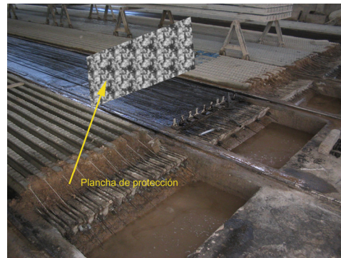
Foto 10: Uno de los bordes de las trenzas de pretensados, aquí se sugiere la fabricación de una protección del operador en caso de que la trenza se suelte estando tensada.
