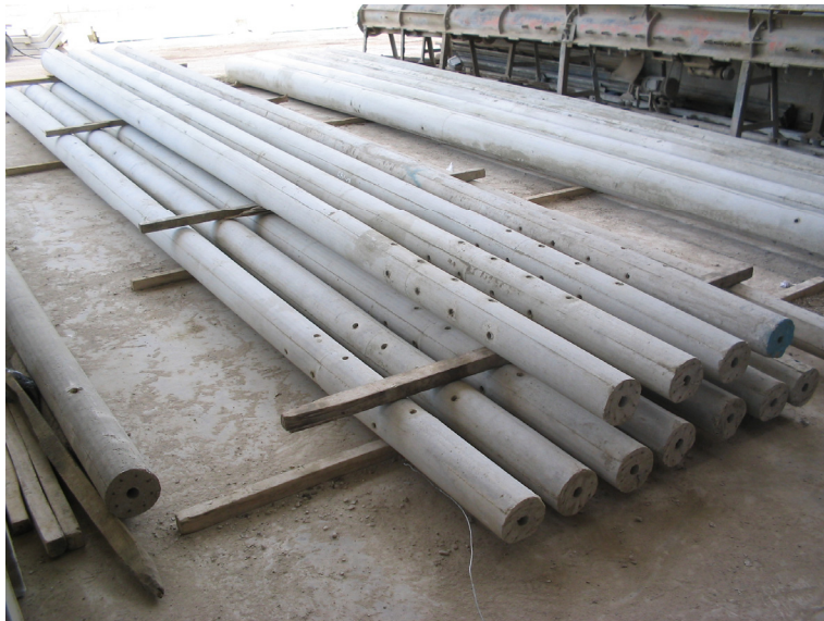
Foto 6: Postes pretensados en su deposito final listos para ser comercializados
