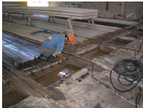
Foto 10: Uno de los bordes de las trenzas de pretensados, aquí se sugiere la fabricación de una protección del operador en caso de que la trenza se suelte estando tensada.
