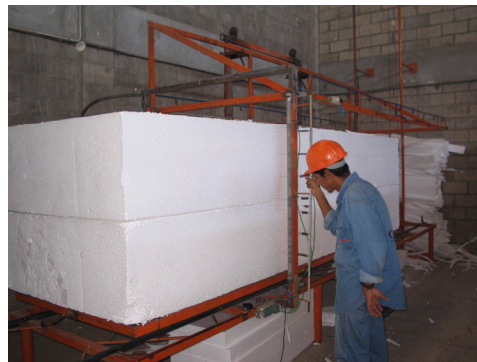
Foto 18: Proceso de corte y moldeado de las piezas de plastiform, en la primera foto se evidencia la falta de EPP en el operador (guantes y filtros de aire).
