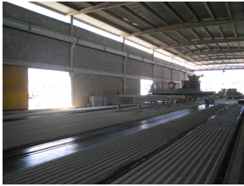
Foto 9: Vista de la nave de PRE-tensados, y la pista de fabricación de las viguetas, se observa la falta de señalización en las salidas y la ausencia de extintores (Tipo B,C).
