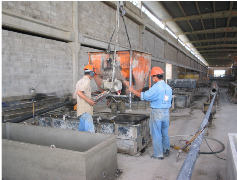
Foto 5: Operadores de premoldeados en plena función de vaciado de un bebedero, están usando EPP de manera apropiada, (el de la derecha tiene protectores auditivos también).
