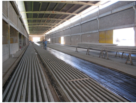
Foto 9: Vista de la nave de PRE-tensados, y la pista de fabricación de las viguetas, se observa la falta de señalización en las salidas y la ausencia de extintores (Tipo B,C).
