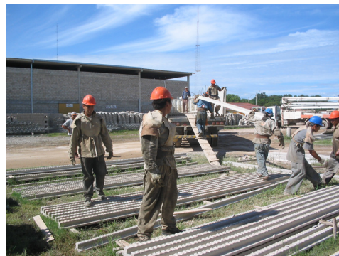
Foto 13: La playa de almacenamiento del producto terminado (Viguetas PRE-tensadas). La plataforma sobre la cual caminan los operadores para subir las viguetas es demasiado inestable y sería necesario diseñar una plataforma de entrega de material.
