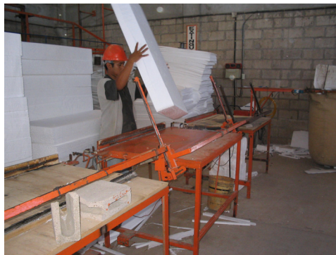
Foto 18: Proceso de corte y moldeado de las piezas de plastiform, en la primera foto se evidencia la falta de EPP en el operador (guantes y filtros de aire).
